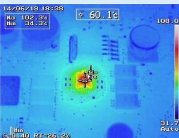
Este equipo puede utilizarse efectivamente en Programas de Mantenimiento Predictivo ya que recoge imágenes termográficas de puntos calientes en motores, bombas, tableros, interruptores y otros puntos de interés para anticipar y corregir problemas potenciales.
