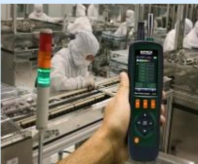
Hemos adquirido un Medidor de Material Particulado de última generación marca EXTECH. Con este nuevo medidor, se tendrá la capacidad de medir 6 tamaños de partículas: 0.3  $\mu\text{m}$ , 0.5  $\mu\text{m}$ , 1.0  $\mu\text{m}$ , 2.5  $\mu\text{m}$ , 5.0  $\mu\text{m}$ , 10.0  $\mu\text{m}$ , adicionalmente se registrarán parámetros de temperatura ambiente y humedad relativa.
