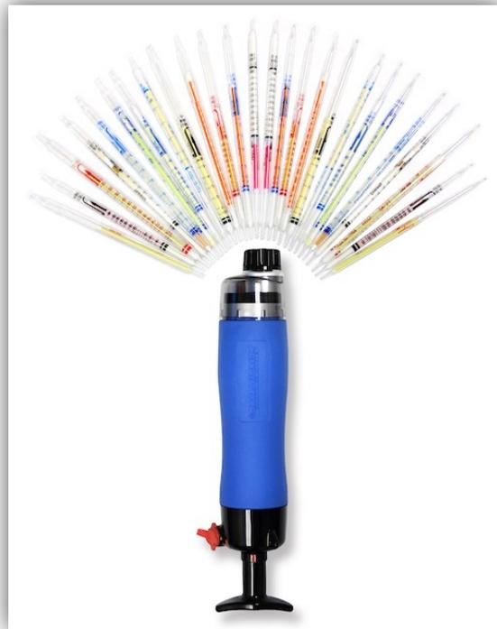
El sistema es perfecto para realizar tomas de muestras de un gas conocido, el sistema de reactivos químicos se almacena en un tubo de vidrio cerrado y reacciona cambiando de color al ponerse en contacto con un gas o vapor. La concentración de la sustancia se caracteriza por la longitud de decoloración, esta concentración se lee directamente de la escala presente en el tubo de muestreo.
