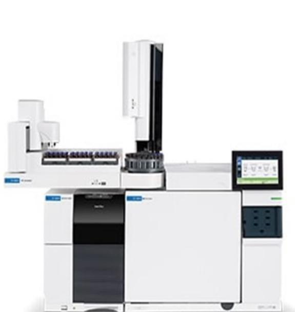
**Cromatógrafo de Gases con espectrometría de masas. Serie 8890 / 5977B**
